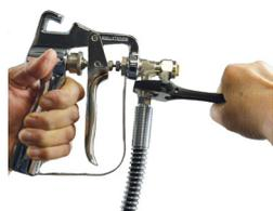
2) Monter le "pistolet de pulvérisation de base" sur le tuyau, en serrant bien l'écrou.
